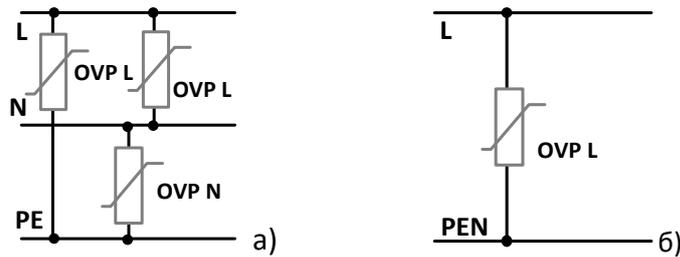
Рисунок 7. Варианты схем подключения УЗИП
